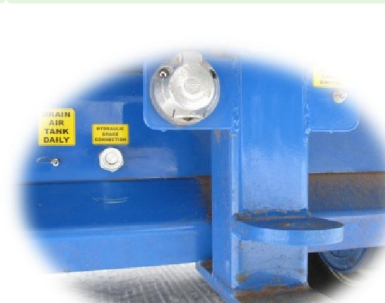
Vakiona takapuskurissa vetokita, valopistoke ja hydraulijarrujen liitin.
