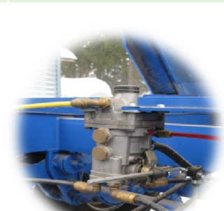
Kuormantuntevat paineilmajarrut säätävät ALB-venttiilillä.
