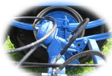
Lehtijousitettu Heavy duty keinuteliakselisto nelipyöräjarruilla.
