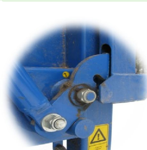
Automaattisesti lukittuva perälaita.
